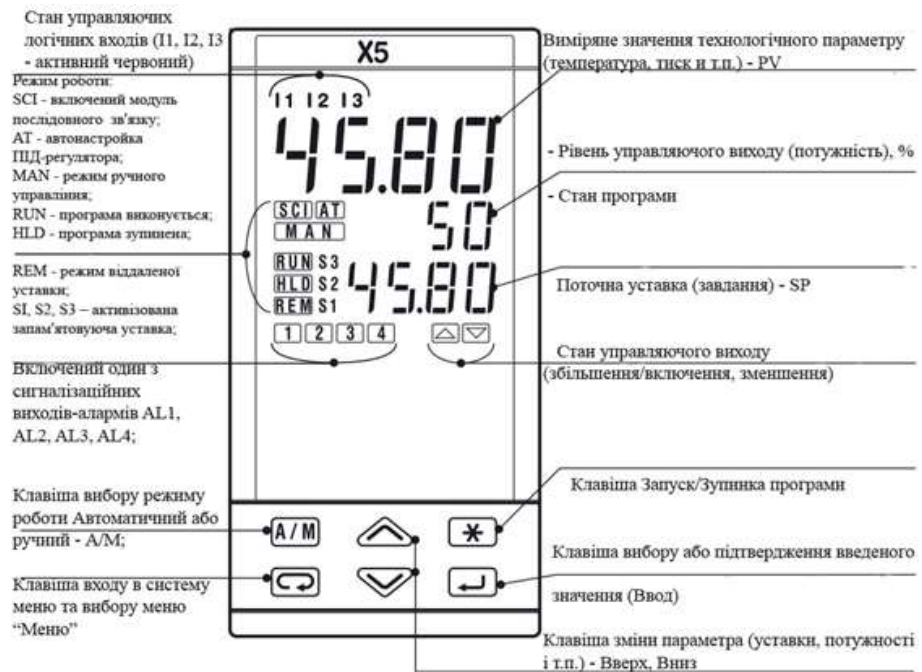
Рисунок 3.1 - Елементи індикації та управління контролера ASCON X5
